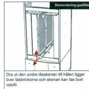
Dra ut den undre låsskenan till hålen ligger över låsbrickorna och skenan kan tas bort uppåt.
