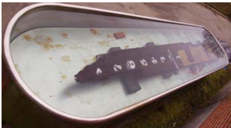
Agterstavnen fra 1800-tallet. Egestavnen vejer cirka et ton og er næsten seks meter lang, og indeholder syv dybdemærker af bly, tre rorlækker af bronze samt en delvis tildækning af messingforhudning.
